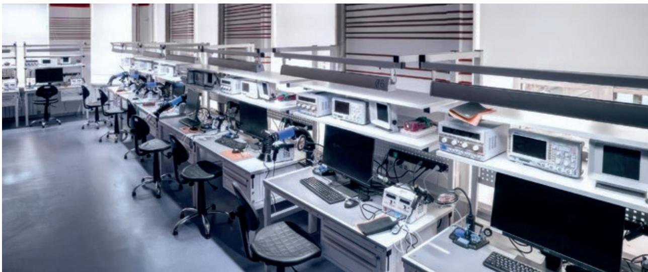
Современные производства электроники и микроэлектроники требуют строгого соблюдения мер защиты от электростатического разряда. Специализированная антистатическая мебель (ESD-мебель) является обязательным элементом таких производств: она обеспечивает безопасную работу с чувствительными электронными компонентами и предотвращает накопление статического электричества, которое может привести к повреждению
