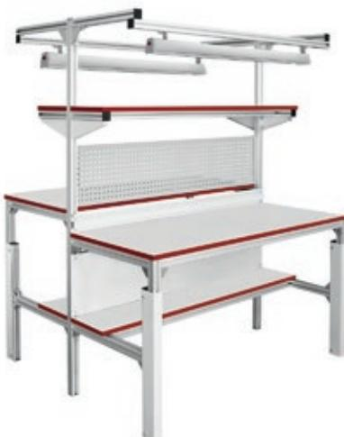
Стол островной СПО-КП изготовлен на базе конструкционного анодированного профиля 45х45 мм. Конструкция стола, состоящая из двух зеркально расположенных столов на едином каркасе, позволяет оптимально использовать производственные и офисные помещения.
